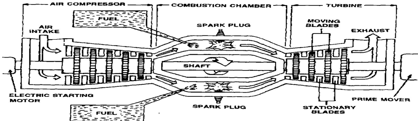
Fig. 2.28: HOW A GAS TURBINE SYSTEM WORKS
